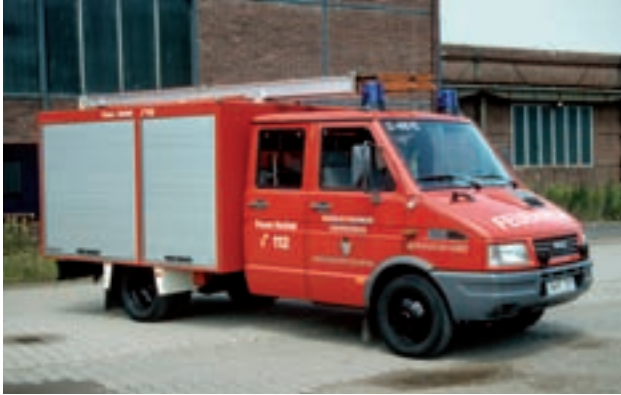
▲ Iveco Turbo Daily 49-10 , TSF-W, Magirus, 1994, FF Gummersbach, Lg. Gelpetal. Bei Fahrzeugen dieser Größenordnung ist das Aufbaudach in der Regel nicht begehbar. Die Leiter kann vom Boden aus entnommen werden.
